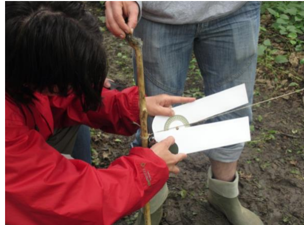
2.6. ábra. A terepi szögmérő eszköz használata (fotó: Makádi M.)
