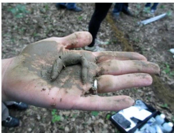
2.10. ábra. Gyúrópróba a terepen (fotó: Makádi M.)
