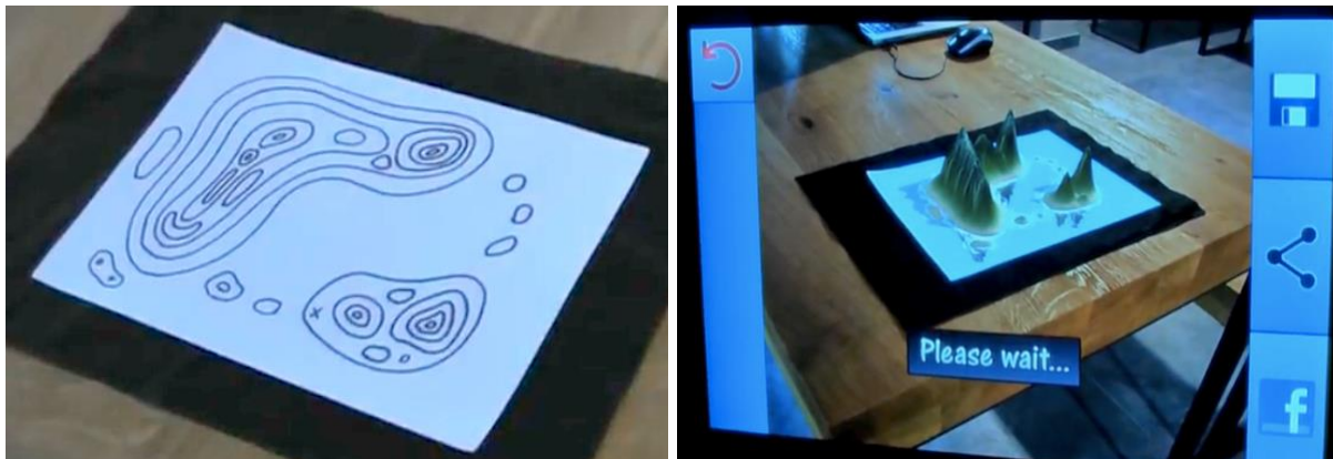
Domborzati kép készítése izovonalakból AR technológiával okostelefonnal (képernyőfelvételek)
