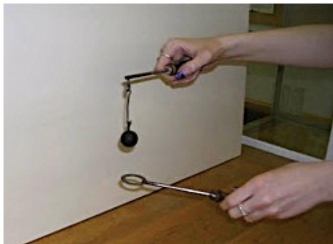
2.9. ábra. A Gravesande eszköz a szilárd testek hőtágulásának vizsgálatához (Radnóti K. felvétele)
