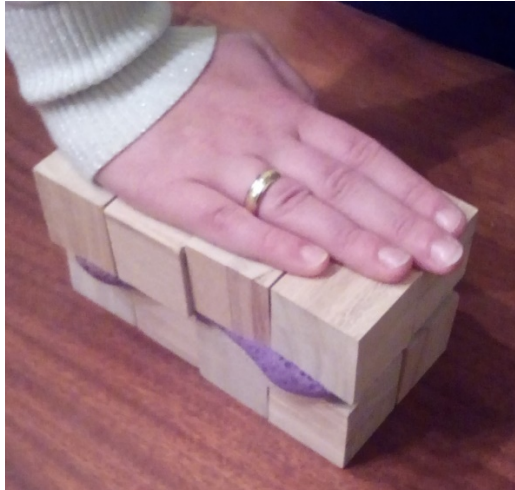
3.kép. A fakockákból és szivacsból megépített „kőzet” kiinduló állapota (fotó: Furtner N.)
