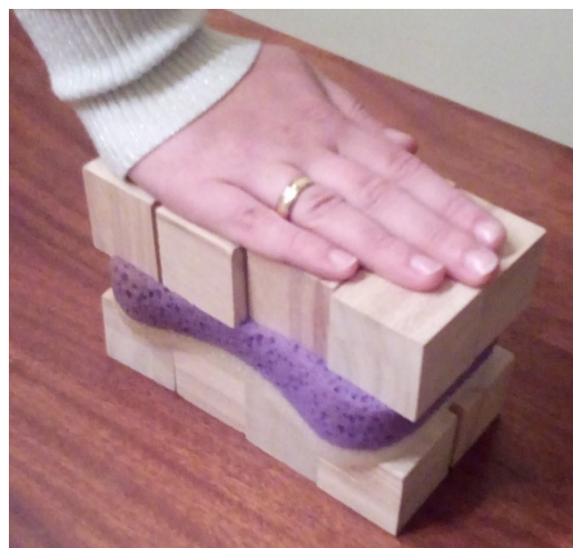
4. kép. Térfogatnövekedés a fagy hatására (fotó: Furtner N.)
