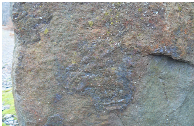
2. kép. Mállási kéreg a Nagy-hársas-kőfejtőből származó andeziten (fotó: Furtner N.)
