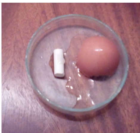
6. kép. Csapvíz csepegtetése tojásbélra és táblakrétára (fotó: Furtner N.)
