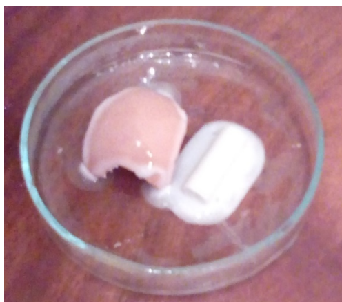
9. kép. Szulfonsav csepegtetése tojáshéjra és táblakrétára (fotó: Furtner N.)
