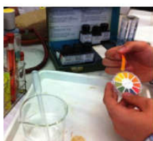
Vízminták kémhatásának meghatározása indikátorpapírral
