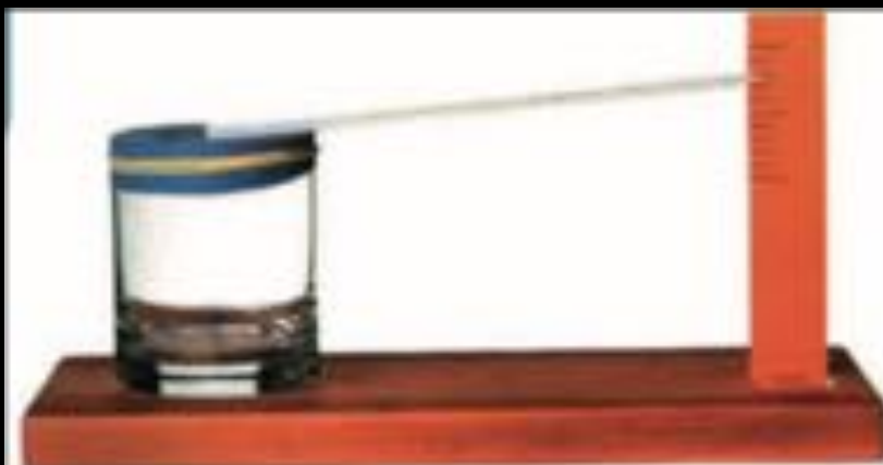
1. Egyszerű készülék a légnyomás változásának kimutatására
