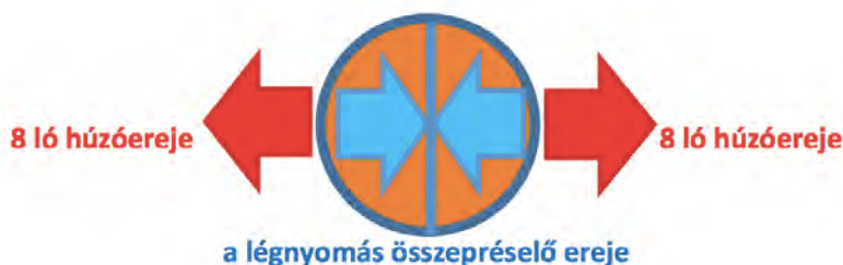
3.11. ábra. A magdeburgi féltekék, és a rájuk ható erők
