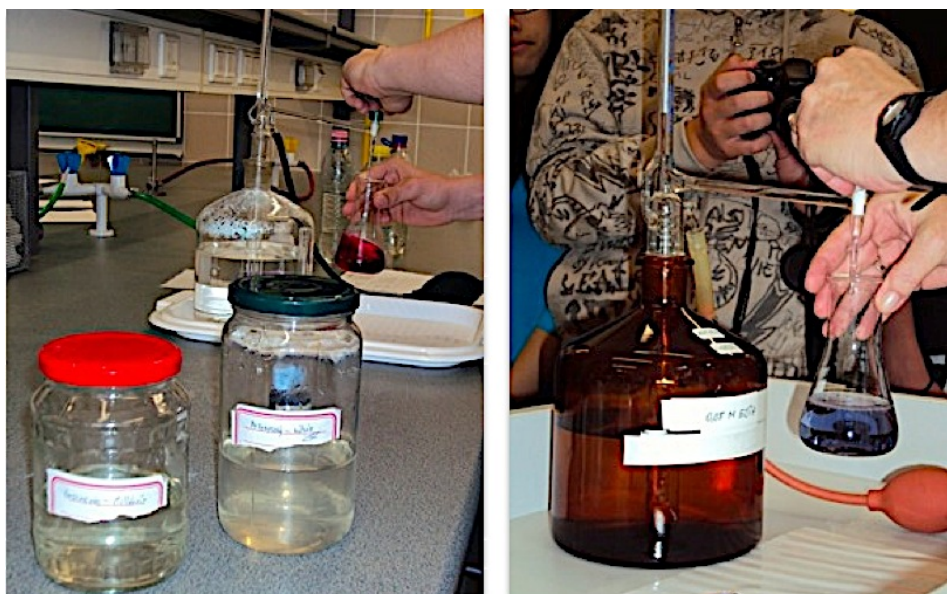
5.10. kép. A víz összes keménységének meghatározása titrálással (fotók: Makádi M. 2011)
