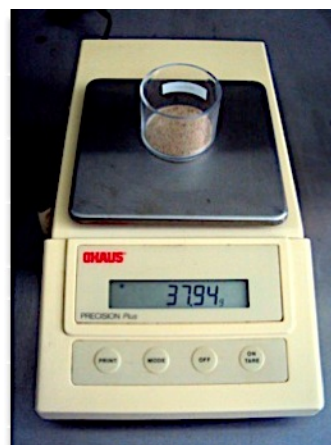
5.7. kép. A lebegtetett hordalék-minta szárítása és tömegének mérése (fotók: Makádi M. 2013)
