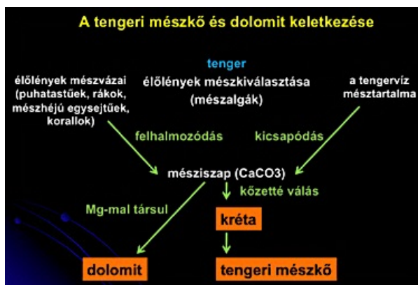
3.2. ábra. A mészkő és a dolomit keletkezésének vázlata (Makádi M. 2013)
