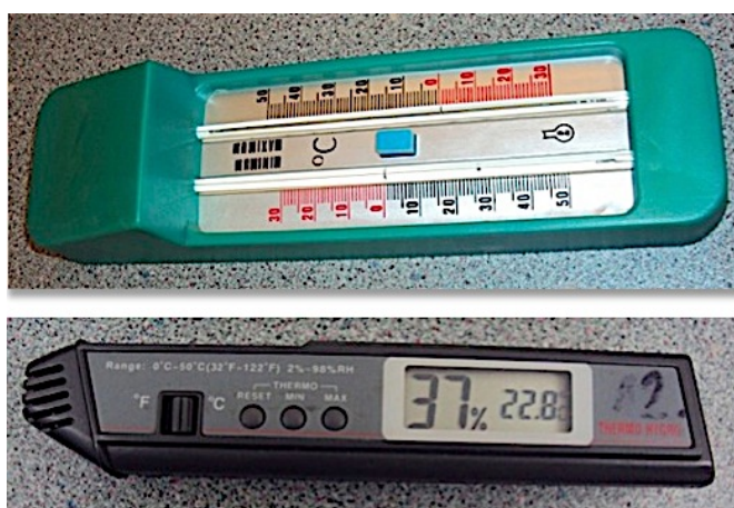
4.3. kép. Maximum-minimum hőmérők: higanyos (fent), digitális kijelzős páratartalom-mérővel (lent) (fotó: Makádi M. 2013)
