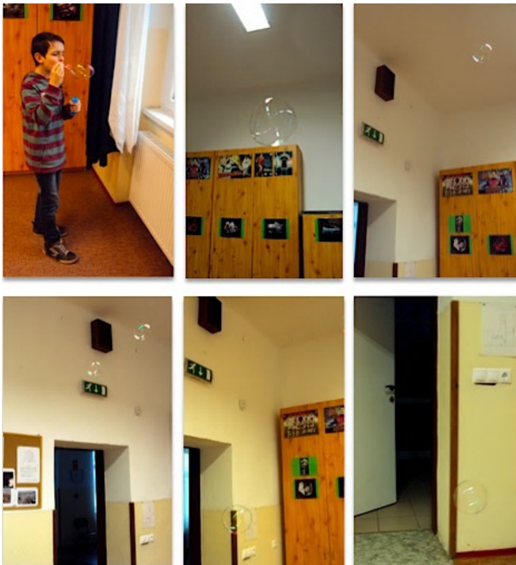
6.47. kép. Légáramlási rendszer modellezése szappanbuborékokkal (fotók: Makádi M. 2013)
