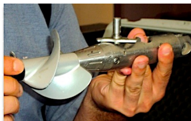
5.3. kép. Vízsebességmérő eszközök: vízsebességmérő bőrönd (balra), kézi forgó vízsebességmérő (jobbra) (fotók: Makádi M. 2012)
