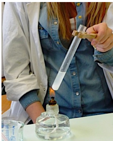
1.6. kép. A kémcsőben való melegítés helyes módja (fotó: Farkas B. P. 2013)
