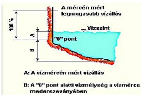
5.6. ábra. A mederteltség értelmezése (forrás: wikipedia – vízállás)
