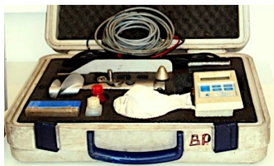
5.3. kép. Vízsebességmérő eszközök: vízsebességmérő bőrönd (balra), kézi forgó vízsebességmérő (jobbra) (fotók: Makádi M. 2012)
