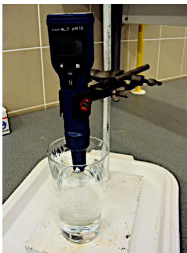
4.13. kép. Esővíz savasságának meghatározása digitális pH-mérővel (fotó: Makádi M. 2013)
