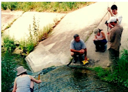
5.4. kép. Vízsebességmérés forgószárnyas sebességmérővel (fotó: Kovács P. 2007)
