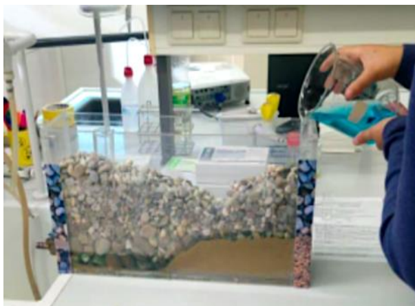
A felszín alatti vizek mozgásának modellezése láthatóvá tétellel (fotó: Deák A.)
