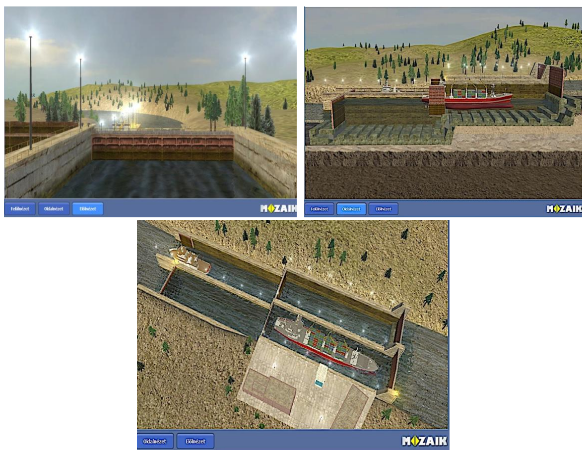
Különböző nézetek megjelenítése 3D animációban – Hajózsili működése (képernyőképek, MozaWeb, Földrajz)
