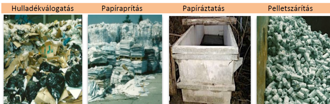
7.6. kép. A biobrikett előállításával kapcsolatos részfolyamatok (fotók: Makádi M. 2008)
