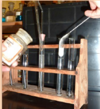
4. Desztillált víz + vasszőg → bedugaszolni vattával + NaCl → lezárni gumidugóval
