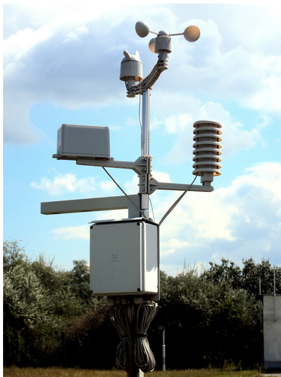
5.4. kép. Automata levegőminőségmérő berendezések (fotó: Makádi M.2010)
