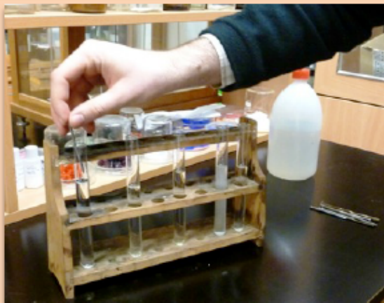
3. Desztillált víz + vasszőg + NaCl → lezárni üvegcsöves gumidugóval
