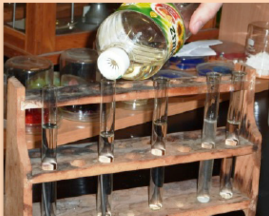
4. Desztillált víz + vasszőg → bedugaszolni vattával + NaCl → lezárni gumidugóval
